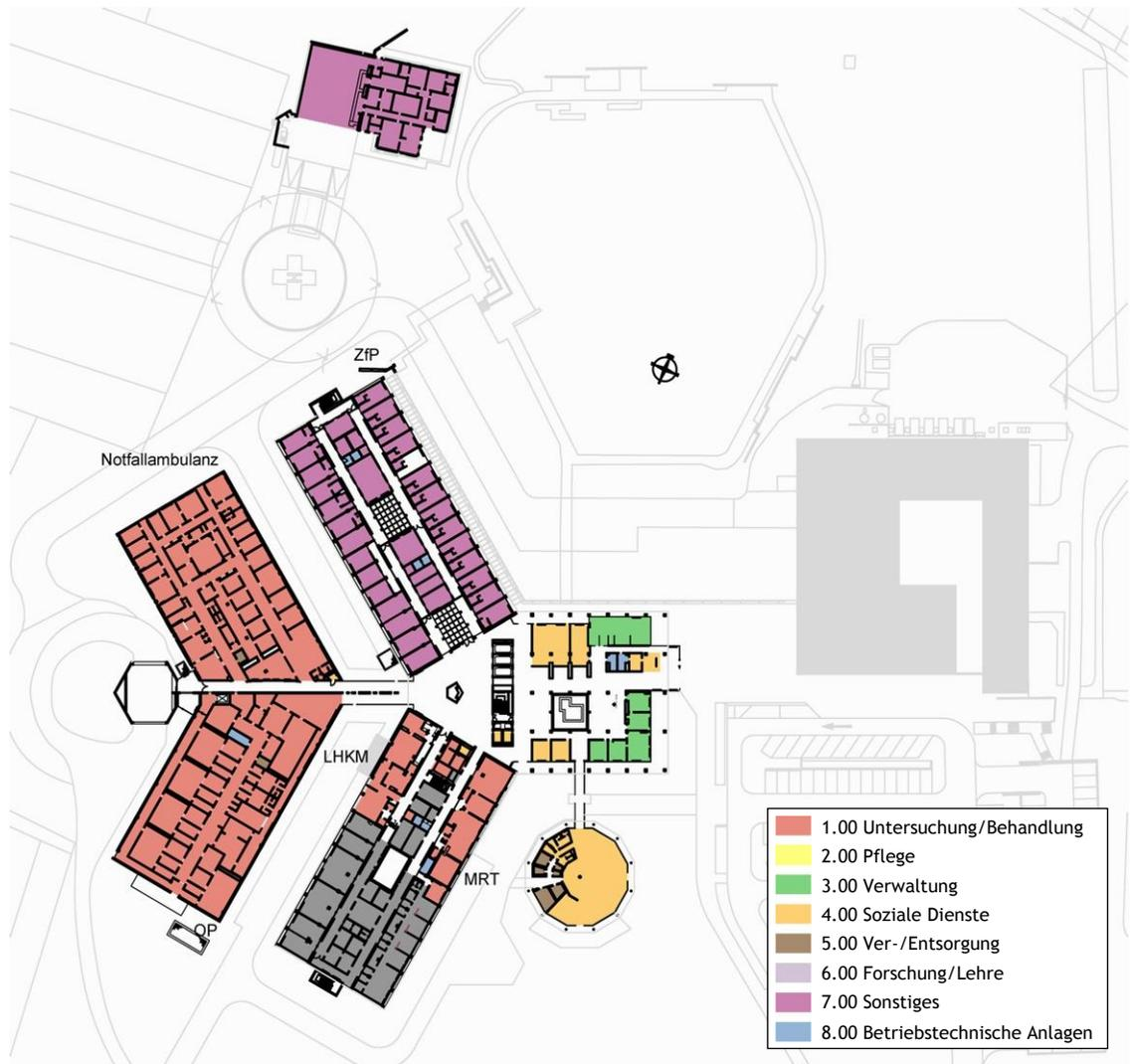
Abb. 5: Bestandsflächen nach DIN 13080 - Erdgeschoss
