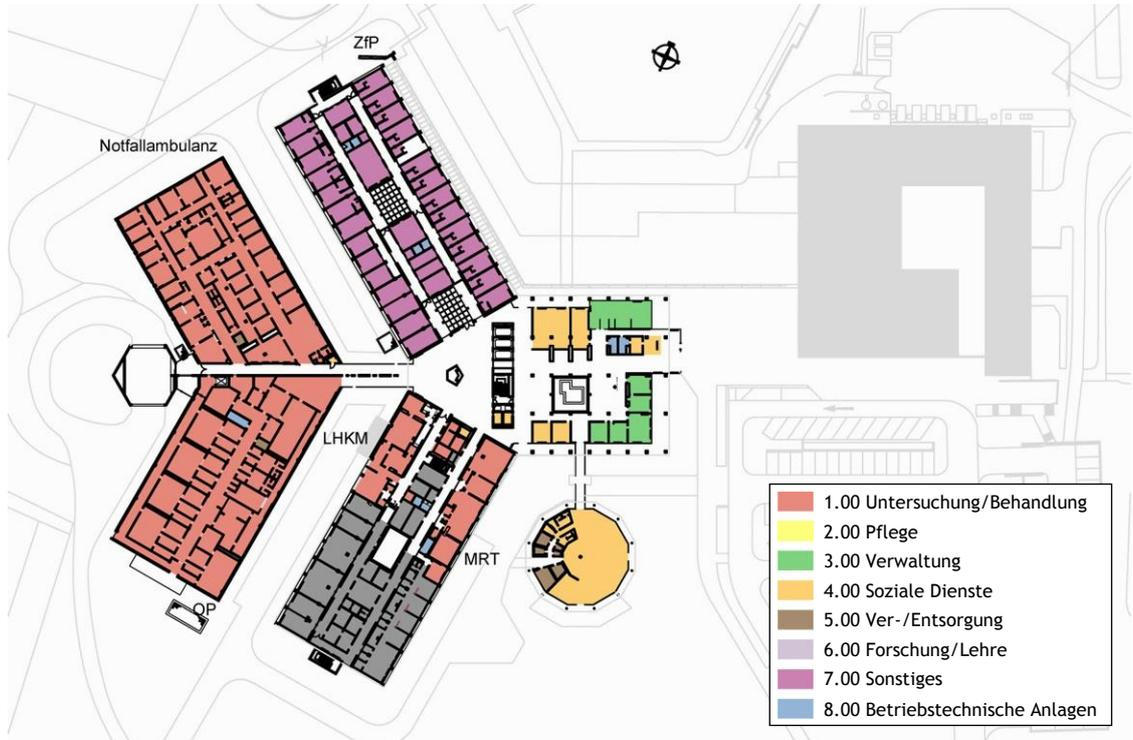
Abb. 14: IST-Flächen nach DIN 13080 - Erdgeschoss
