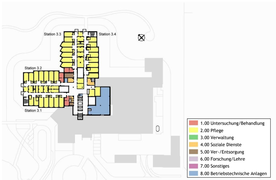
Abb. 8: Bestandsflächen nach DIN 13080 - 3.Obergeschoss
