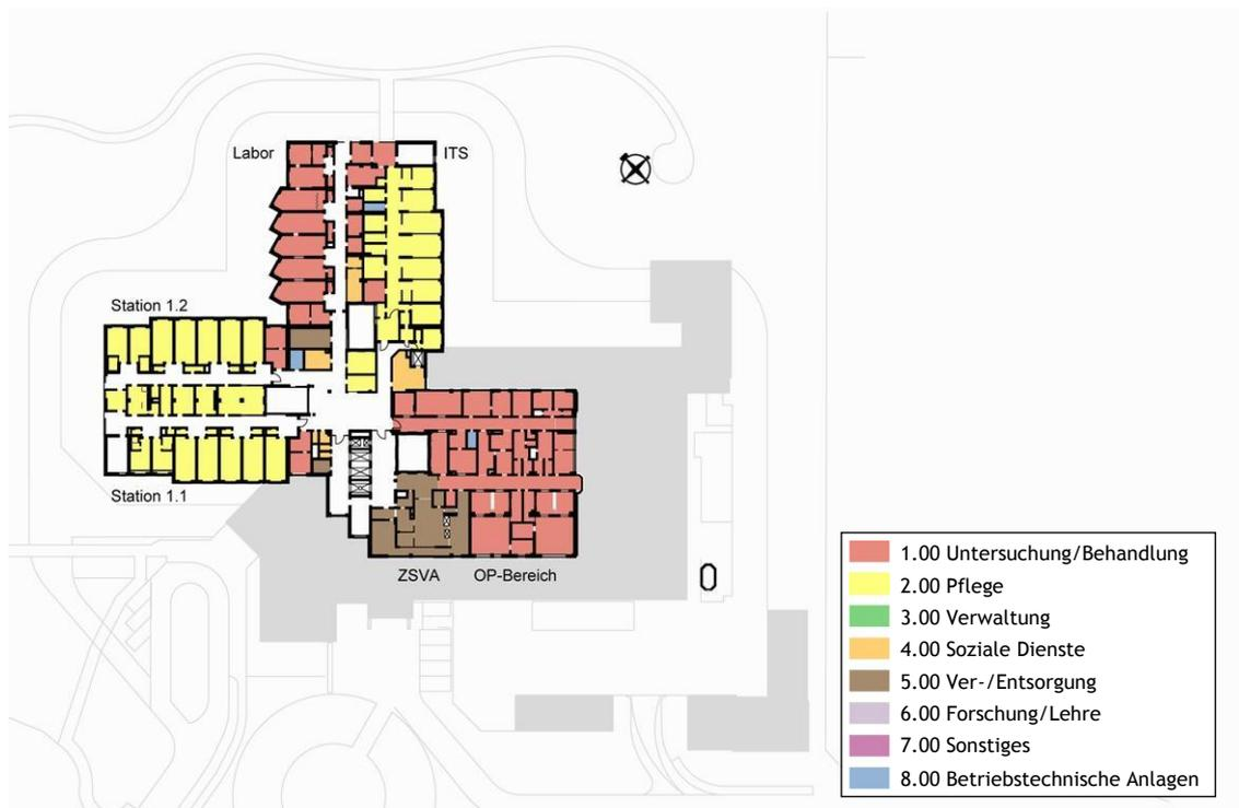
Abb. 6: Bestandsflächen nach DIN 13080 - 1.Obergeschoss
