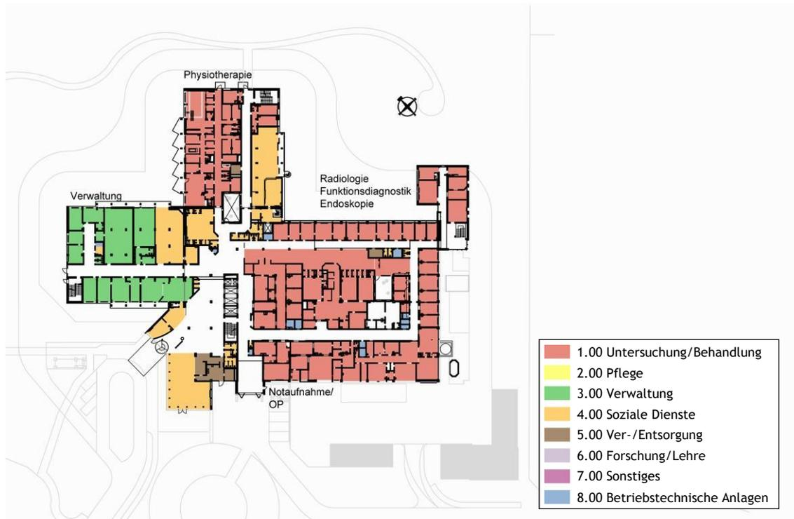
Abb. 5: Bestandsflächen nach DIN 13080 - Erdgeschoss
