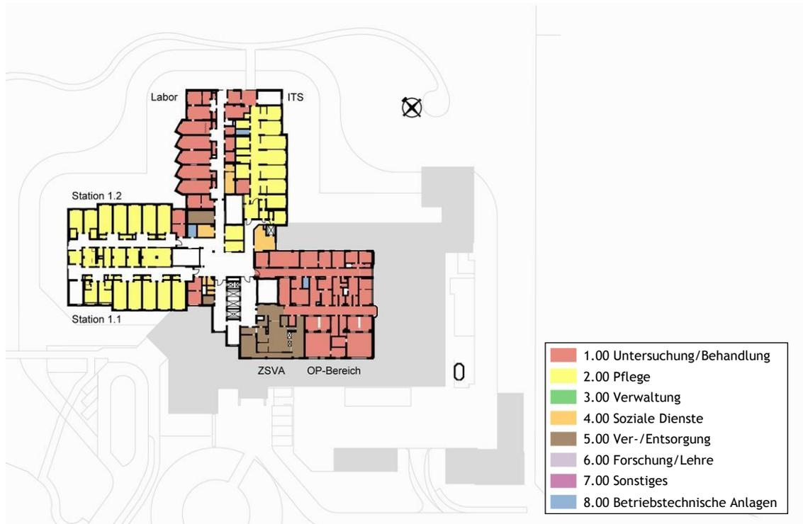
Abb. 14: IST-Flächen nach DIN 13080 - 1.Obergeschoss
