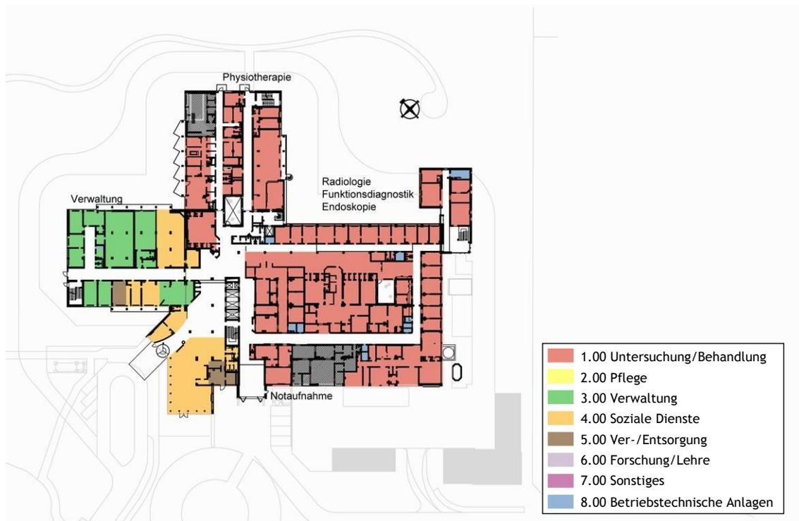
Abb. 13: SOLL-Flächen nach DIN 13080 - Erdgeschoss
