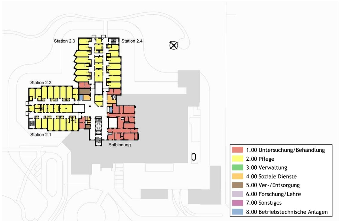
Abb. 16: IST-Flächen nach DIN 13080 - 2.Obergeschoss
