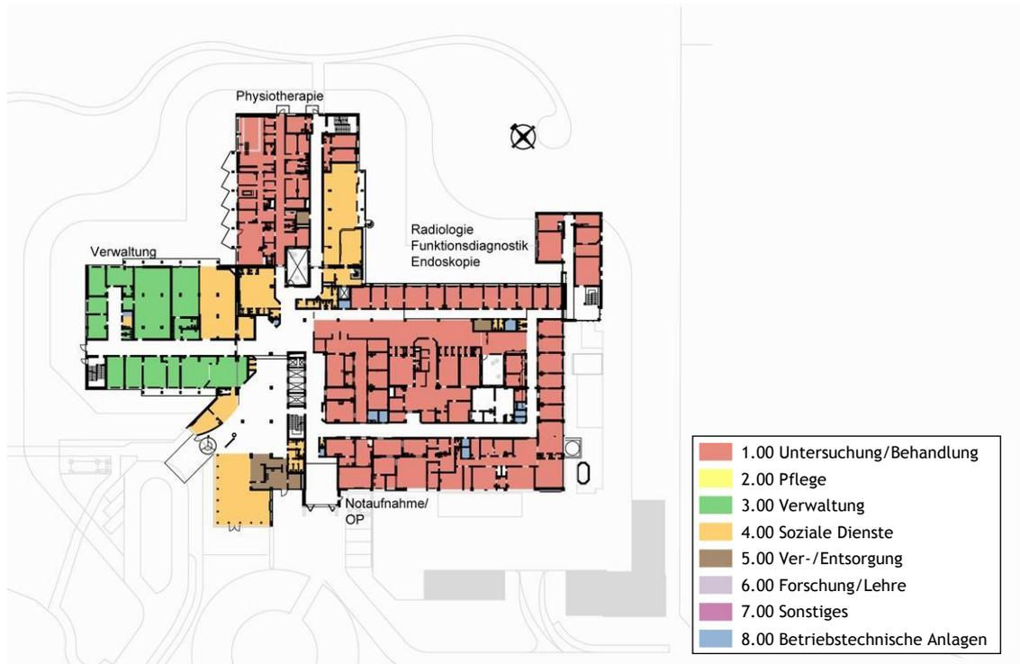
Abb. 12: IST-Flächen nach DIN 13080 - Erdgeschoss
