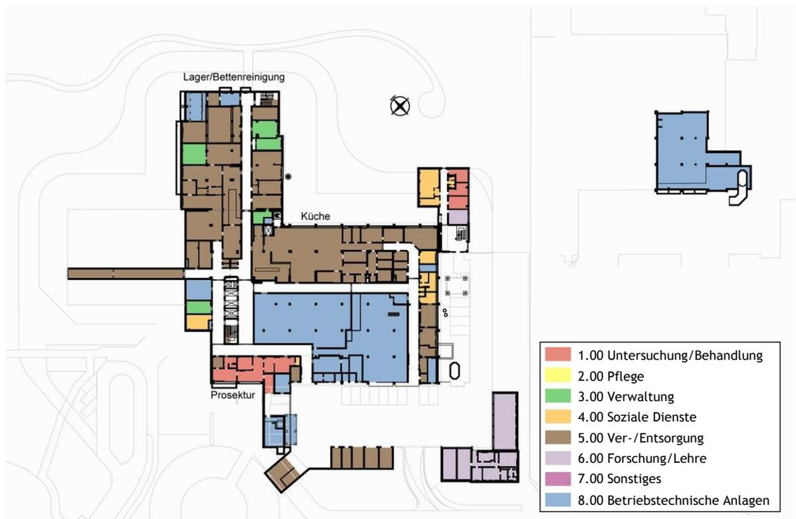
Abb. 10: Bestandsflächen nach DIN 13080 - 1. und 2.Untergeschoss
