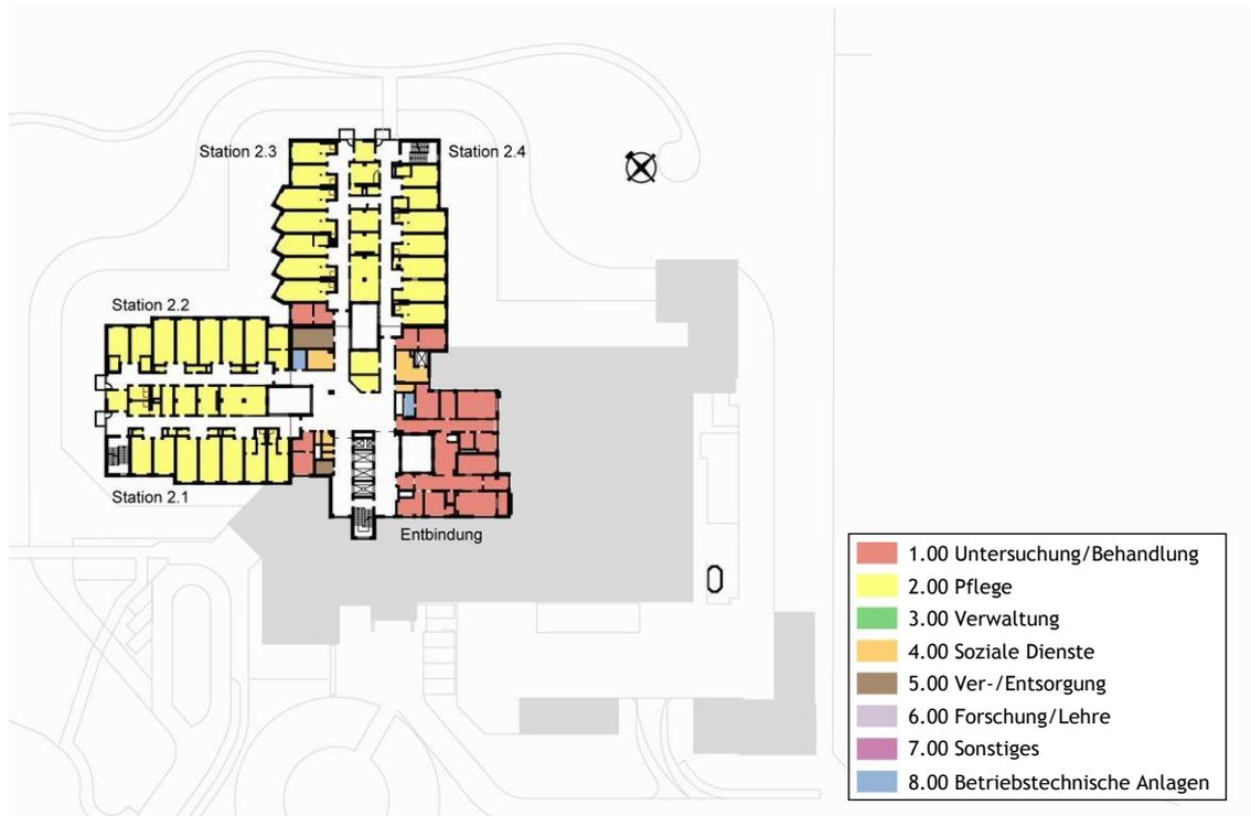
Abb. 7: Bestandsflächen nach DIN 13080 - 2.Obergeschoss
