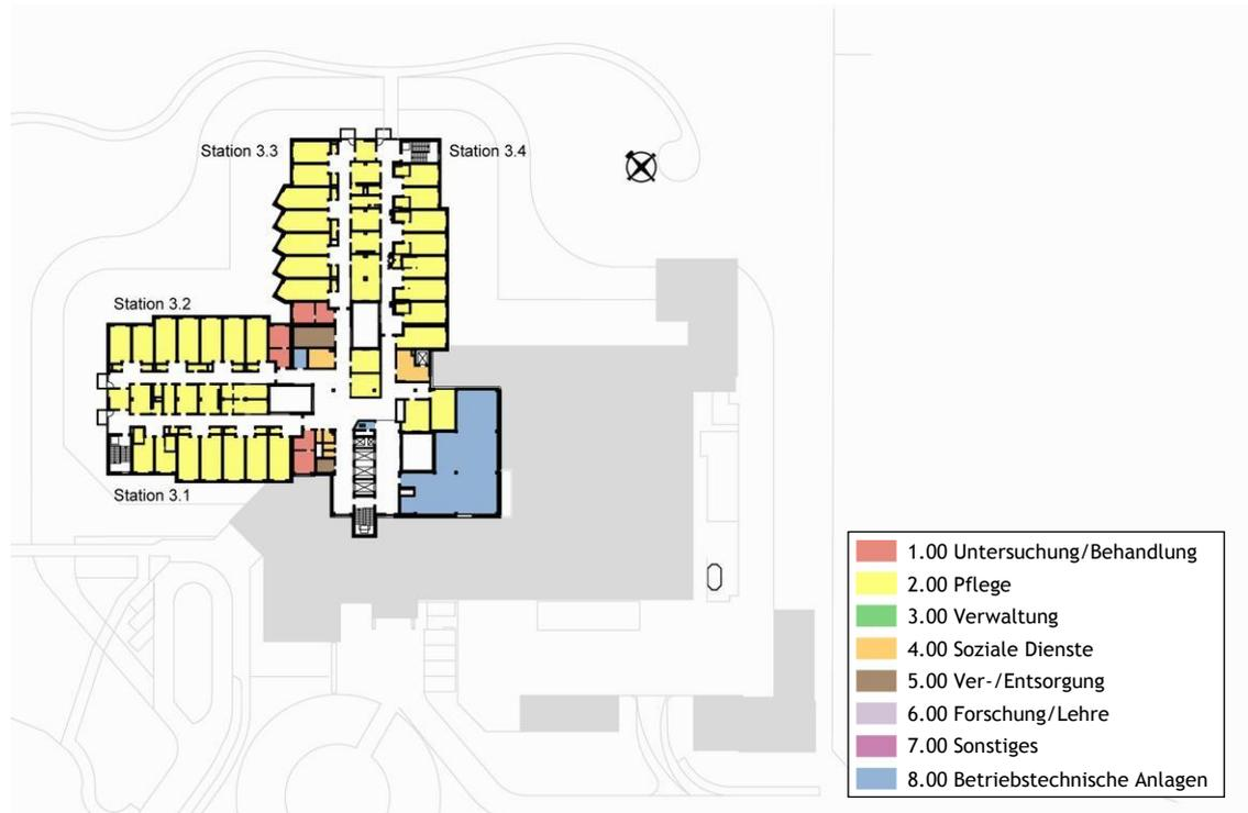
Abb. 18: IST-Flächen nach DIN 13080 - 3.Obergeschoss
