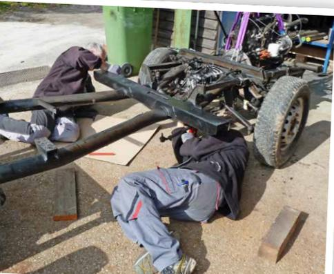
L 3017: Der generalüberholte Motor wird wieder eingebaut.
