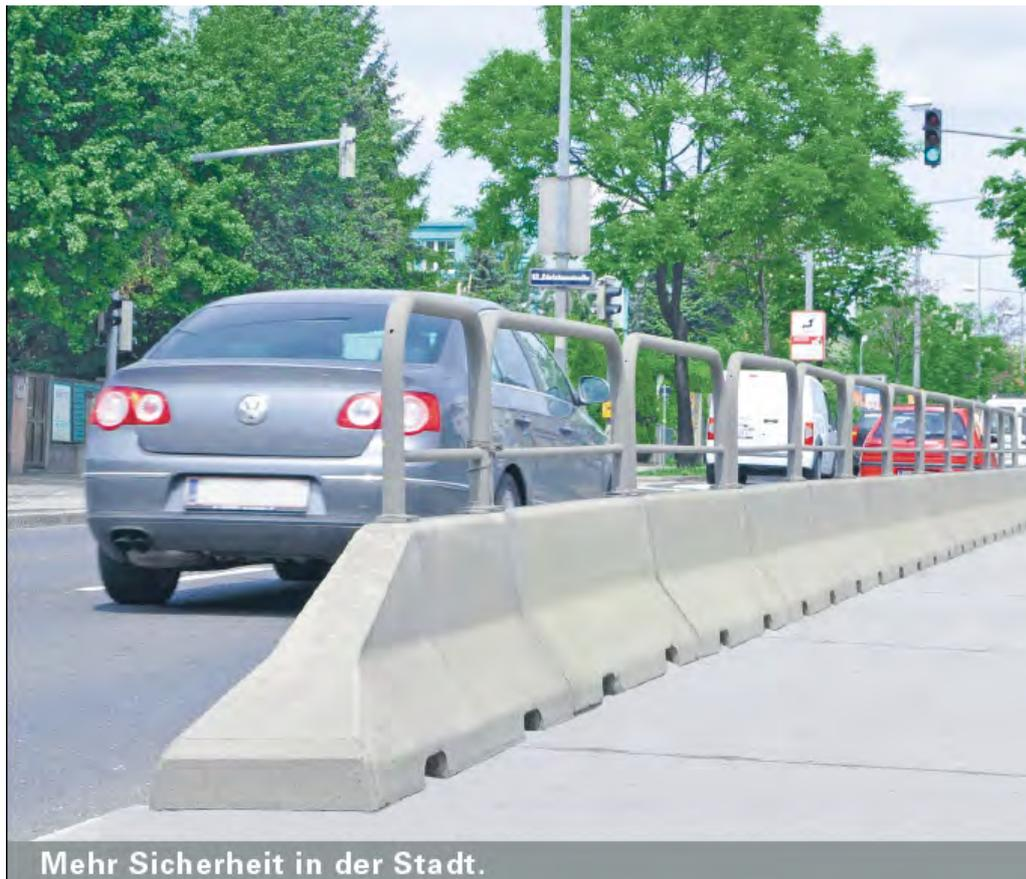
**Bild 6:** Innerstädtisches Trennelement Cityblock mit Aufsatzgeländer als Trennung zwischen Fahrbahn und Radweg
