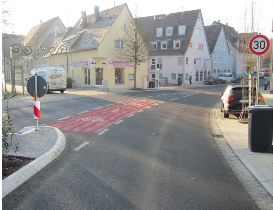
Abb. 7-10: Querungshilfe mit nachgelagerter Aufstellfläche für linksabbiegenden Radverkehr
